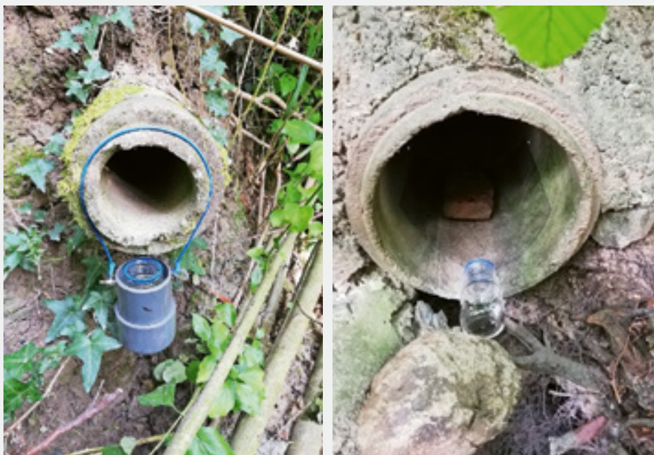
Fig. 8 Dispositif de l'échantillonnage en continu dans les exutoires d'eaux claires suite à la détection d'un écoulement par temps sec.
