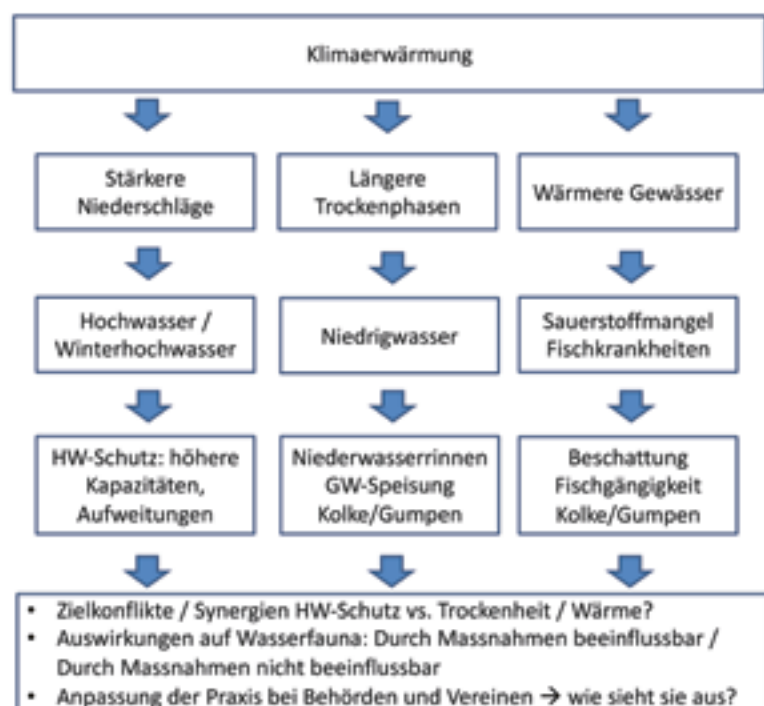
Fig. 1 Klimaauswirkungen auf den Wasserbau.
