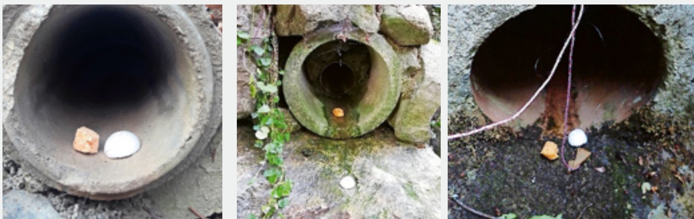
Fig. 6 Dispositifs de détection des écoulements d'eau dans les exutoires d'eaux claires: une demi-sphère en polystyrène expansé et une éponge compressée.
